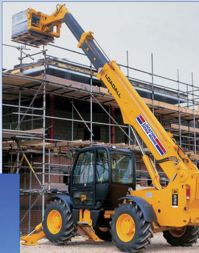
B Chariot élévateur - mât télescopique 6000 - 7000 lbs
