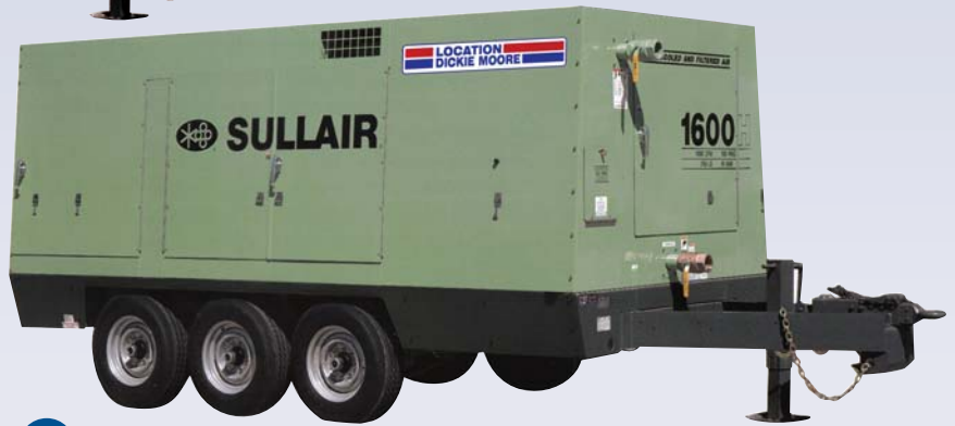
D Compresseur 1600 PCM - Air Filtré
