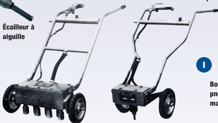
J Bouchardeuse à air - 7 pistons
